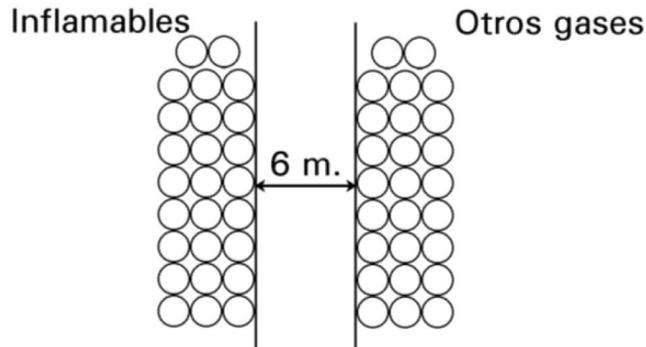
Nota: Con respecto a la separación entre recipientes conteniendo gases inflamables y gases inertes, se considerará una distancia de 3 m.
