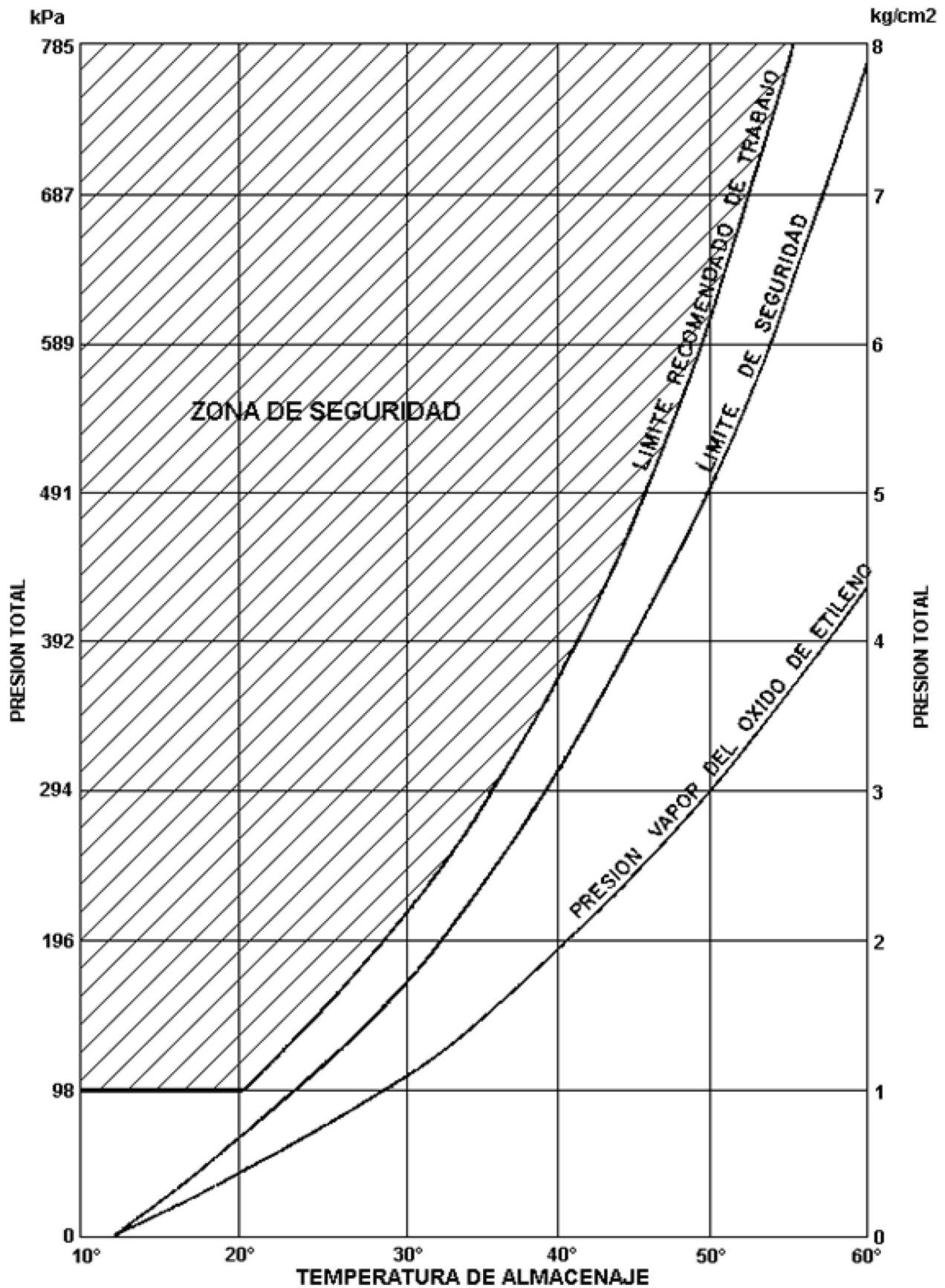
Figura 1.- CONDICIONES DE TRABAJO DEL OXIDO DE ETILENO
